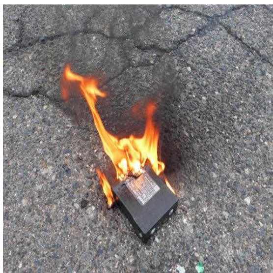
発火した充電電池
